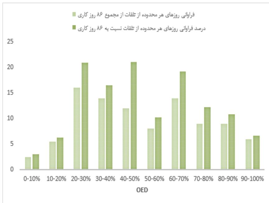
نمودار ۱. توزیع مقدار ناکارآمدی کلی دستگاه در ۸۶ روز کاری (بیانگرهای پژوهش)
